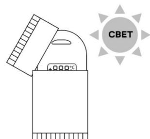
**1)** Извлеките Датчик из светонепроницаемой упаковки в условиях достаточной освещенности. Включение Датчика произойдет автоматически в течение 1 (одной) минуты.
